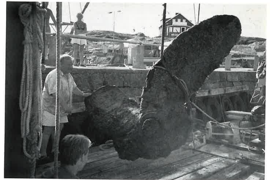
Endast två av bladen fanns kvar när JOHNs propeller bärgades. Men axeltätningen var intakt efter 75 år på havsbotten!
